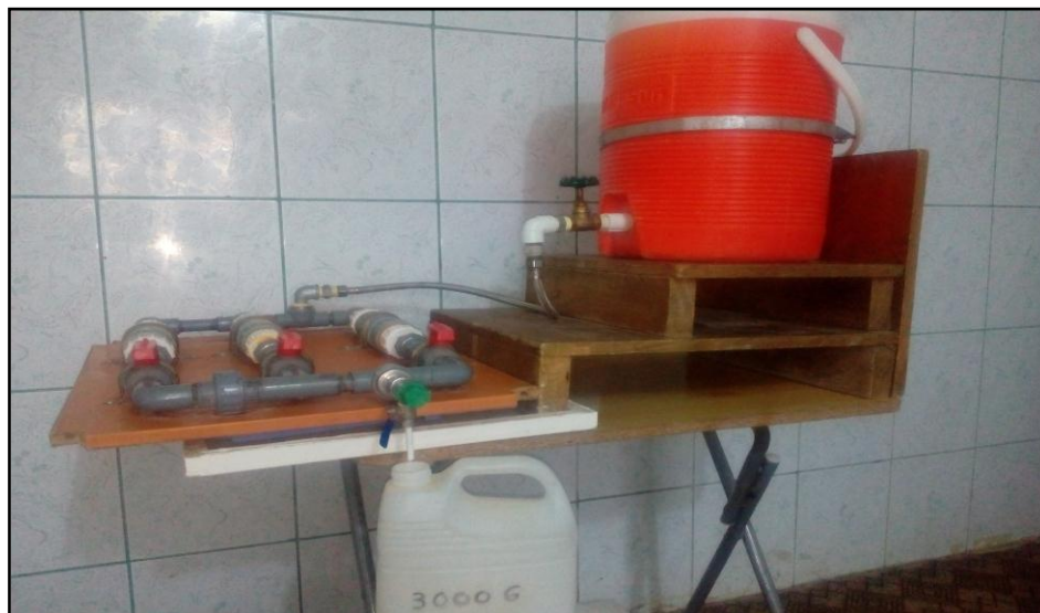
صورة 1. جهاز معالجة الماء مغناطيسياً (جهاز المغنطة).
